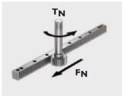
Obr. 4-1 Princip funkce ozubeného hřebene a pastorku [9]
