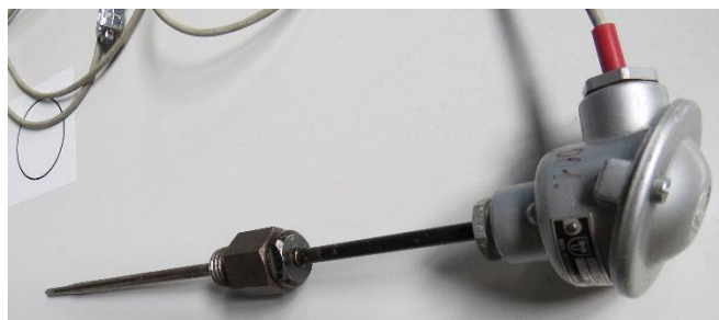
Obr. 20 platinové teplotní čidlo PT100/2-200+600°C
