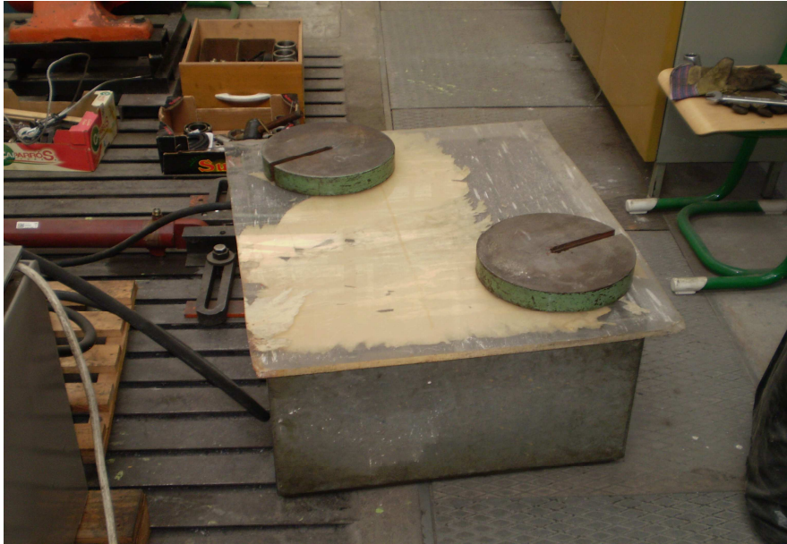
Obr. 34 – Zakrytí pokusu ochranným plexisklem
