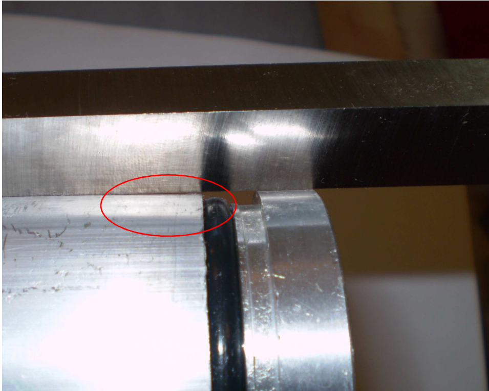
Obr. 36 – Průběh plastické deformace u závěrných členů
