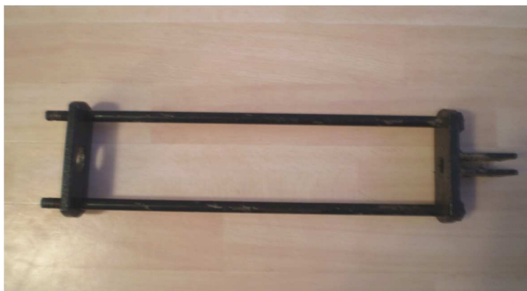
Obr. 4 – Stahovací svorníky a příruby pneumatického válce
