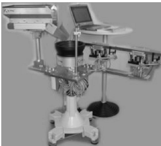
Obr. 3: Robot s pevnou sekvencí [2]
