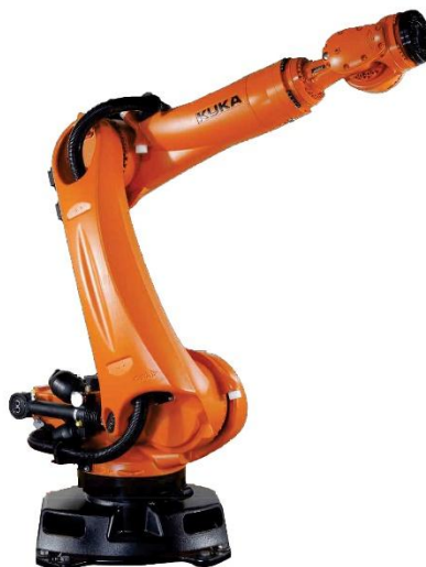
Obr. 10: Průmyslový robot KUKA KR 90 R2700 určený pro vysoce přesné aplikace jako například laserové měření [30]
