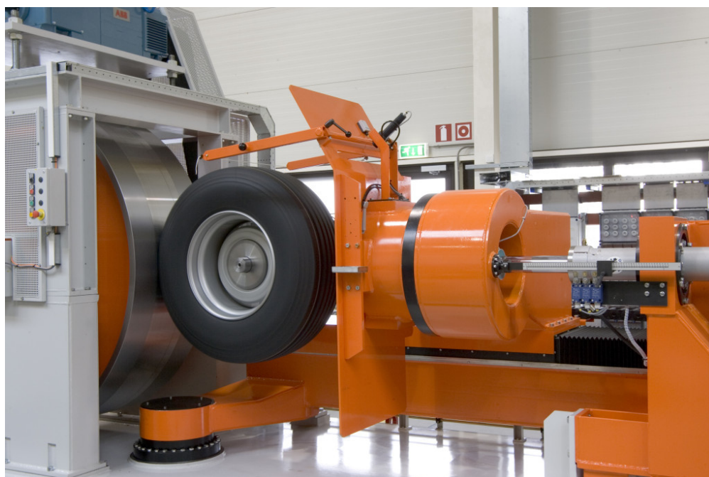
Obrázek 5.2.: Testování kola automobilu na stroji s odvalovacím bubnem (převzato z [12])
