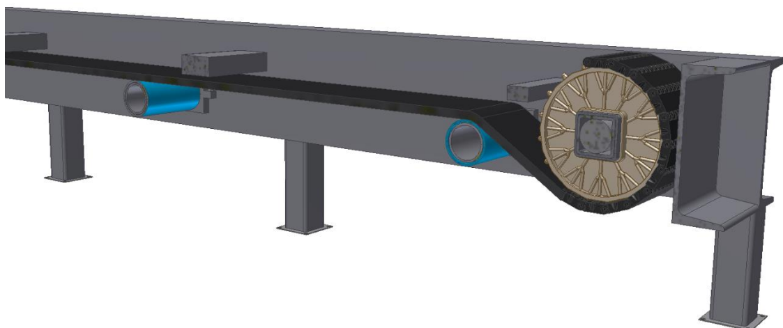
obr. 21: Podpory zpětného pohybu pásu
