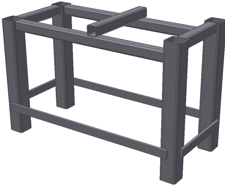
obr. 23: Základní konstrukce rámu pro motor a převodovku
