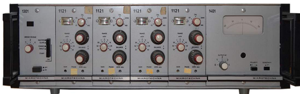
Obr. 23 – Tenzometrická aparatura Mikrotechna
