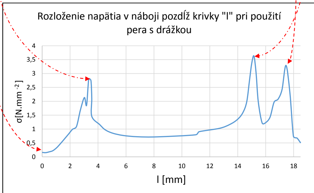
Obr. 29 Rozloženie napätia v drážke náboja po kontakte s perom s drážkou
