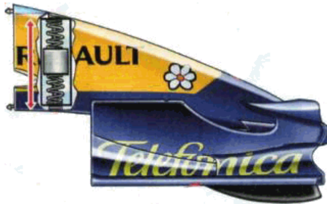
Obr. 2.1: Dynamický tlumič ve voze Renault F1 (Technical F1 dictionary)
