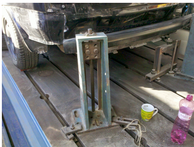
Obrázek 2.3. Detail dosavadního uchycení za nárazník a tažné oko.
