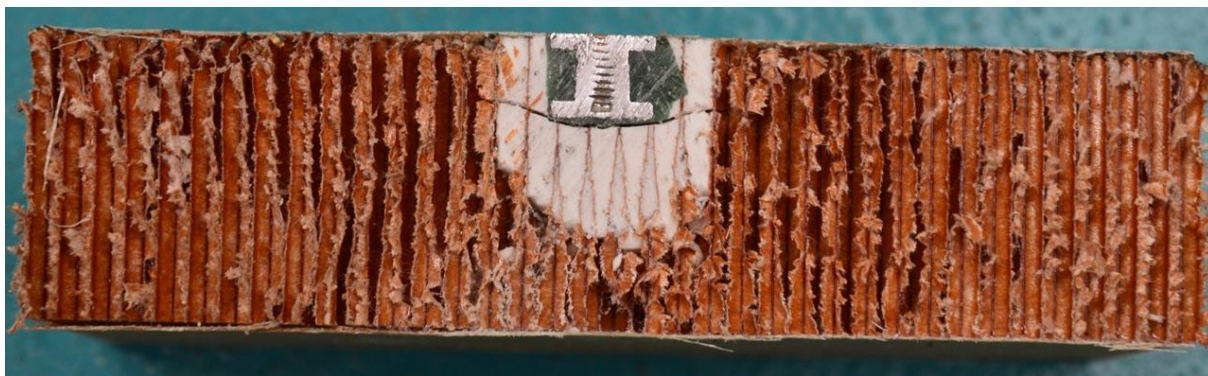
Obr. 5.12: Porušení plniče při částečně zapuštěném insertu
