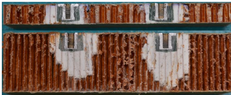
Obr. 5.13: Řez vzorku s plně zapuštěným insertem (nahore), Řez vzorku s částečně zapuštěným insertem (dole)
