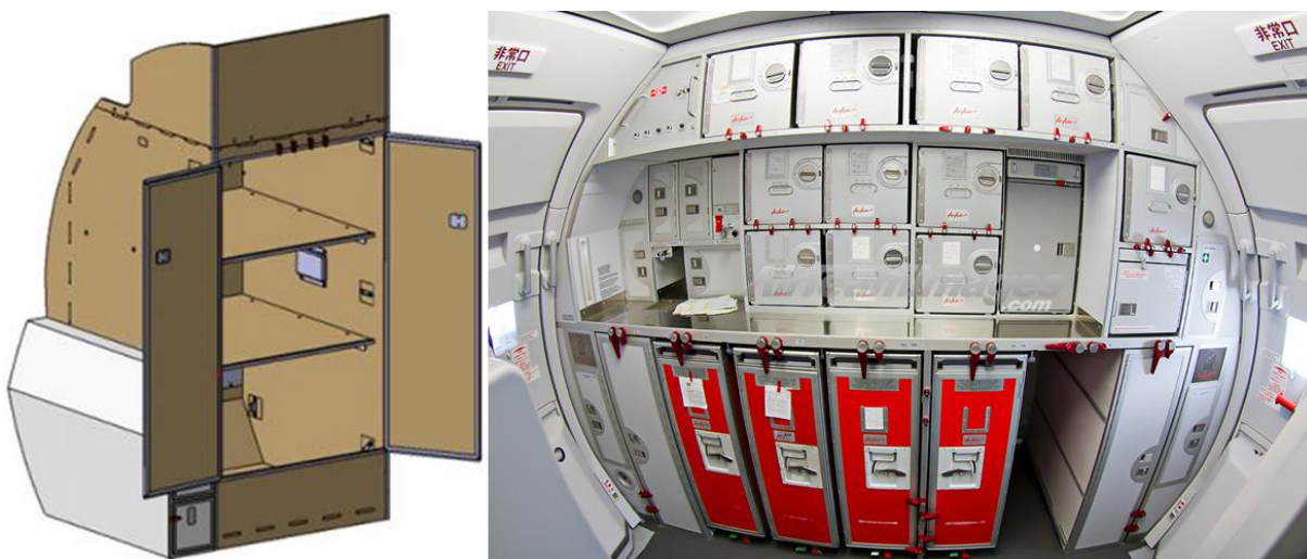
Obr. 1.1: Ukázky interiérových aplikací s využitím sendvičových struktur [12, 14]
