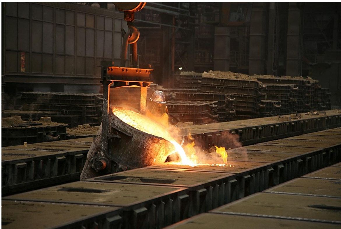
Obrázek 8: Licí proces z pánve do formy na Formovně 2a
