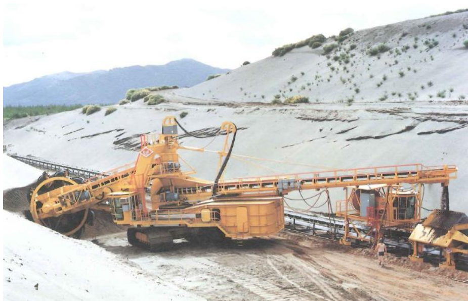
obr. 2.: Kompaktní kolesové rypadlo S400 při těžbě železné rudy [9, str. 126]
