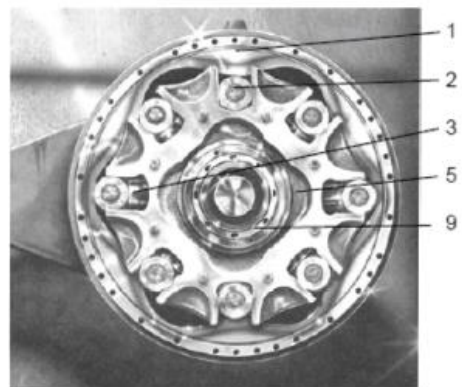
Kde: 1 - křivková dráha, 2 - odvalovací kladka, 3 - píst, 5 - rotující blok pístů, 9 - ventilová deska (rozváděč)
