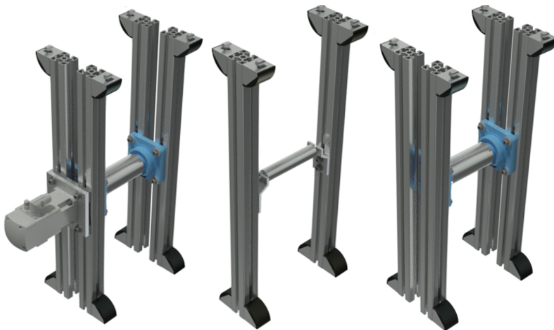
Obrázek 4.3: Sestavné celky hnacího bubnu, válečku a vratného bubnu
