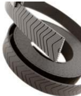
Obr. 8 - Plochý polyuretanový pás s ocelovými lanky [6]
