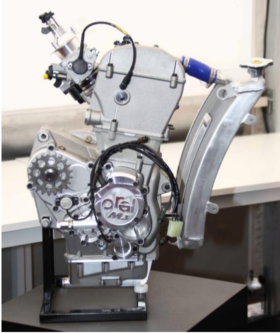
Obr. 5, 6: Motor Oral OR-2504T pro kategorii Moto3 (zdroj: www.omnimoto.it )
