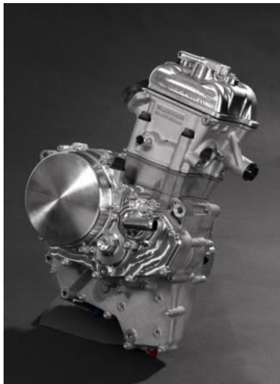
Obr. 3: Motor Mahindra MGP30 pro kategorii Moto3 (zdroj: www.motociclisimo.es )
