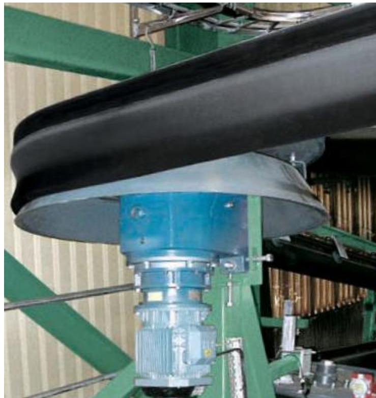
obr.12.: Zatáčka v horizontální rovině pod malým úhlem včetně pohonu [16]
