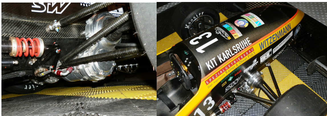
Obrázek 3.6: Motor s planetovým převodem umístěný pod monokokem
