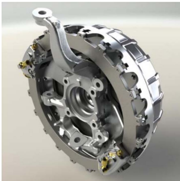
Obrázek 2.6: Motor Protean - zástavba brzdového kotouče a třmenů
