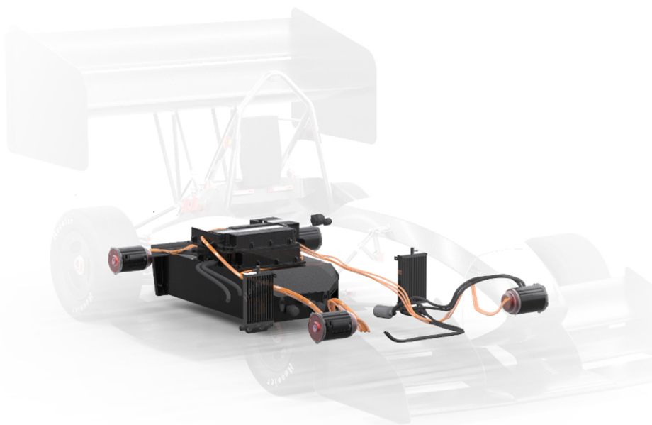
Obrázek 3.7: Pohonné ústrojí vozu s nábojovými motory (AMZ)[13]
