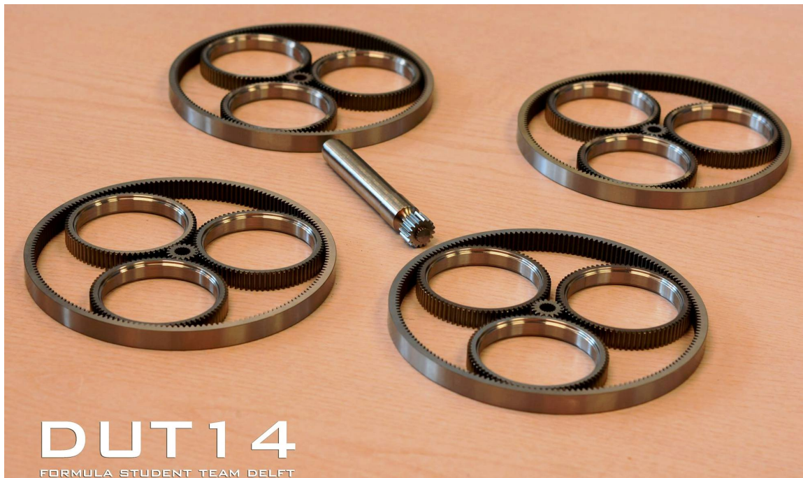
Obrázek 3.12: Planetové převody a hřídel motoru vozu DUT14
