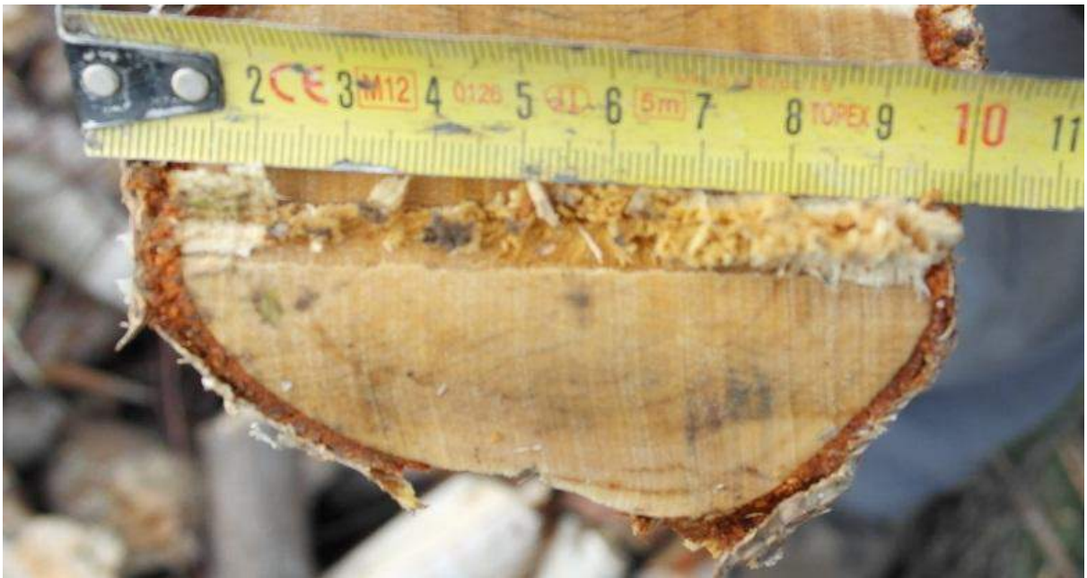
obr.43.: Napěchovaný materiál široký 5 mm uprostřed březové větve ( převzato z [25] )
