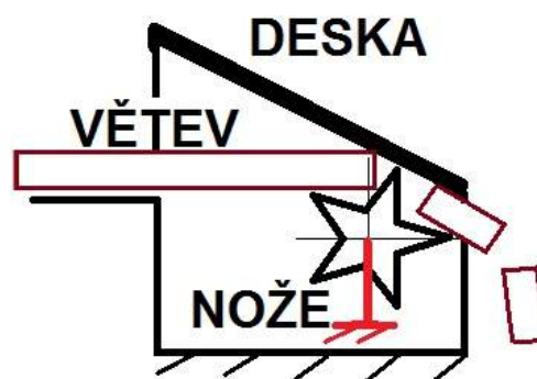
obr.7.: Princip jedno-rotorového stroje
