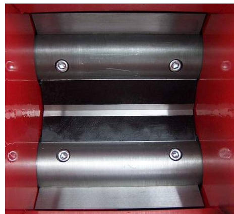
obr.13.: Sekací ústrojí špalíkovače, ( převzato z [6] )
