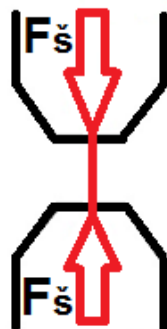
obr.12.: Štípací síly v jedné rovině
