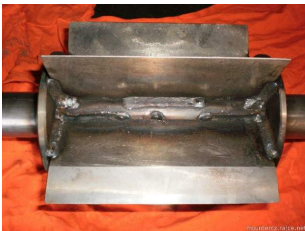
obr.6.: Svařenec nožové hřídele (převzato z [9])
