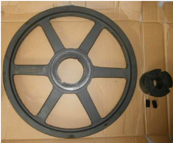
obr.56.: Velká řemenice o průměru 500 mm, vpravo montážní pouzdro Taper lock
