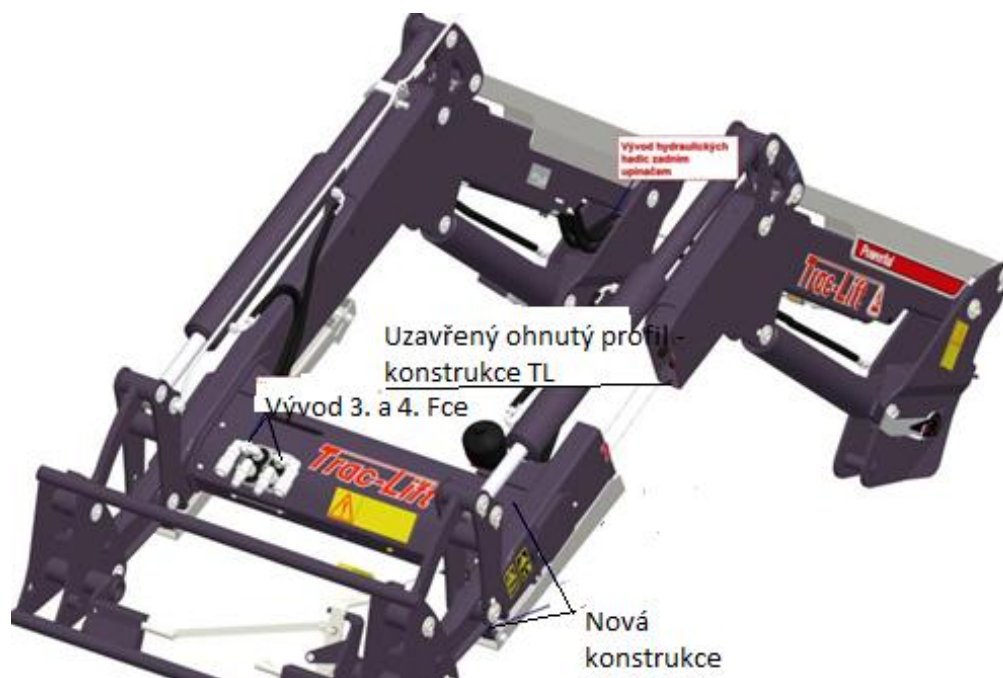
Obrázek 6.: Konstrukce ramen nakladače [4]
