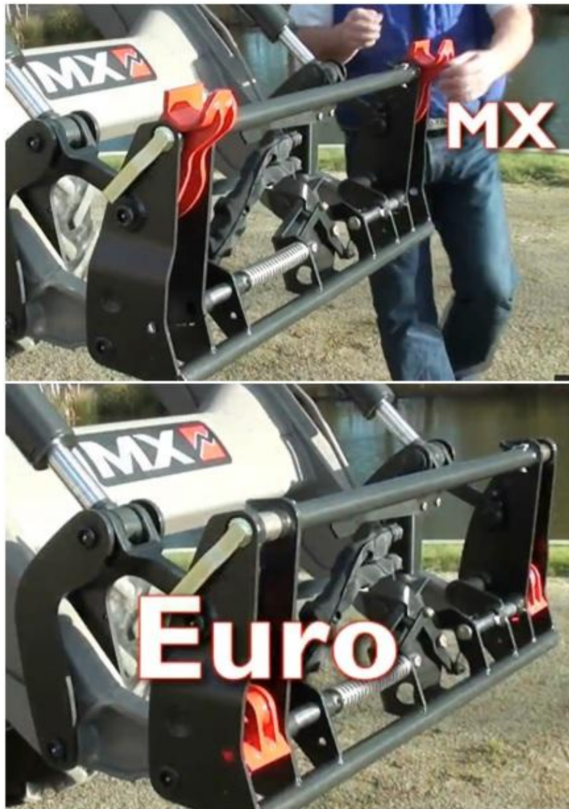
Obrázek 20.: Ukázka systému MX a jeho přestavba na Euro [11].
