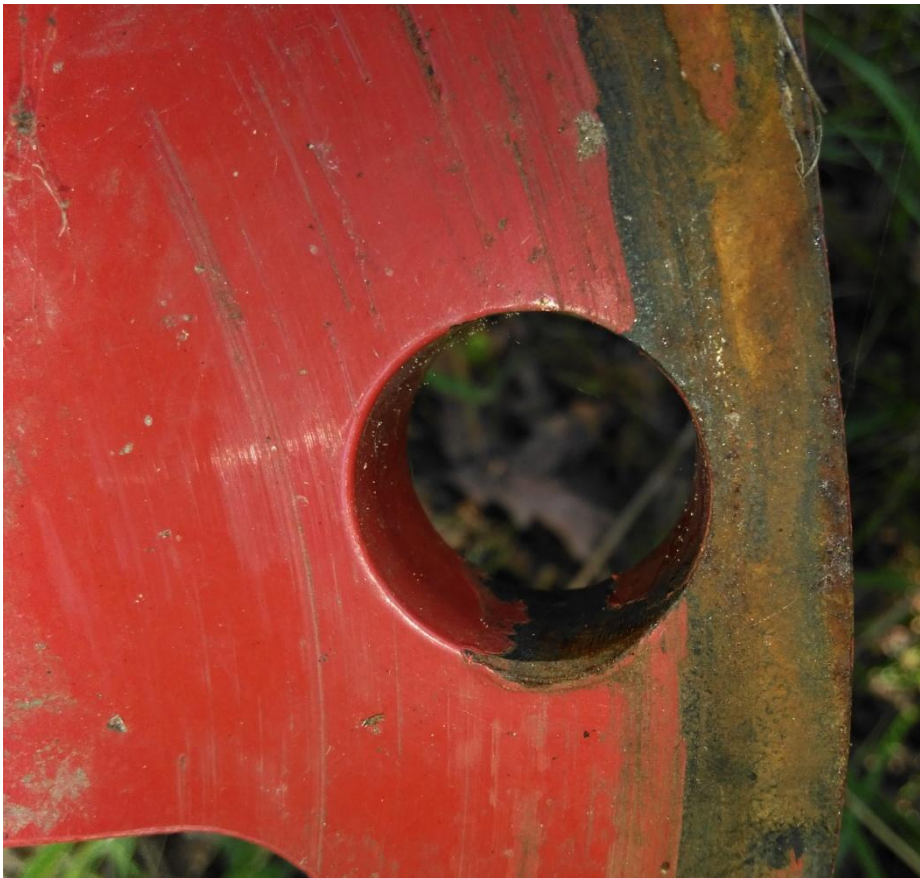
Obrázek 54.: Ilustrační ukázka místa otlacení v díře čepu
