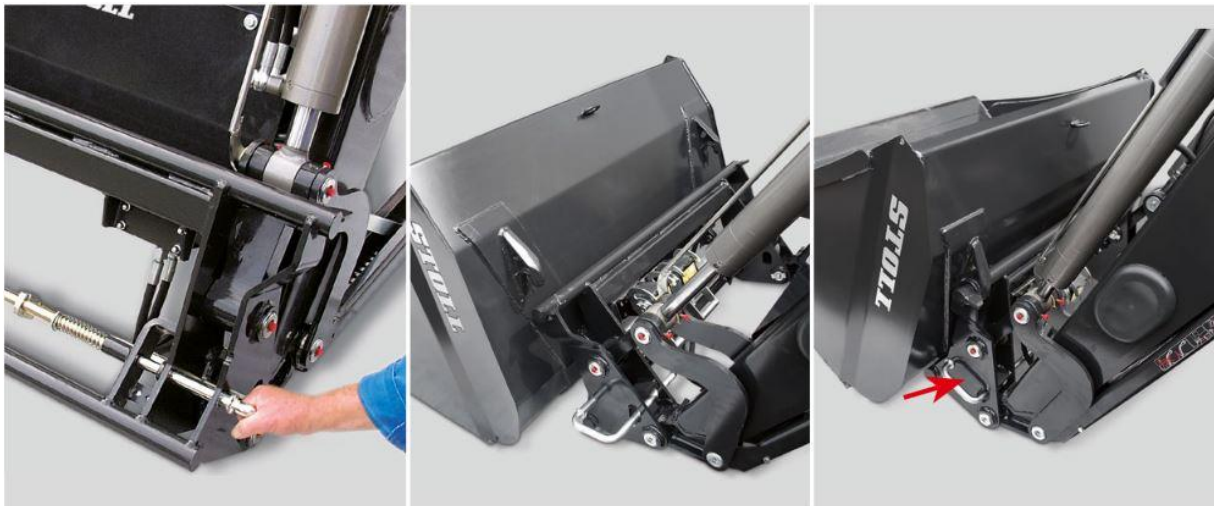
Obrázek 42.: Upínání nástroje pomocí suvné kulatiny (zleva): 1- odjištění, 2- nájezd do nářadí, 3- zajištění nářadí. [12]
