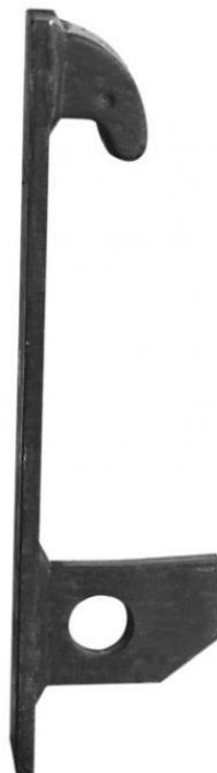
Obrázek 12.: Detail části ALÖ upínacího systému před aplikací na nástroj [10].
