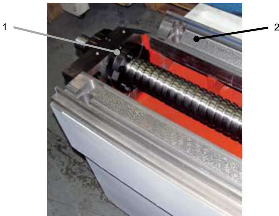
Obr. 5-2 Lože stolu s ukotvením kuličkového šroubu [19]
