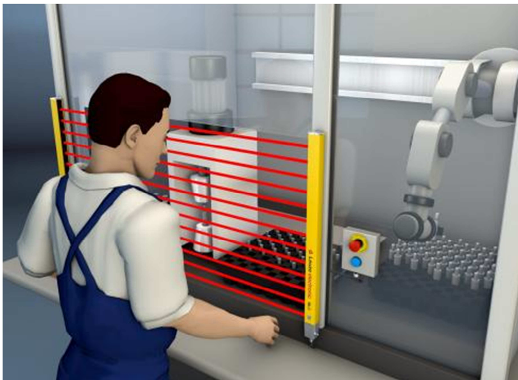
Obr. 3.14 Ukázka použití optických závor při nutnosti vstupu obsluhy do pracovního prostoru [15]
