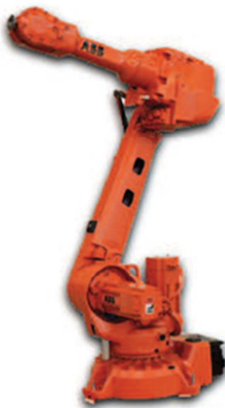
Obr. 3.2 Příklad robotu se sériovou kinematickou strukturou společnosti ABB [9]
