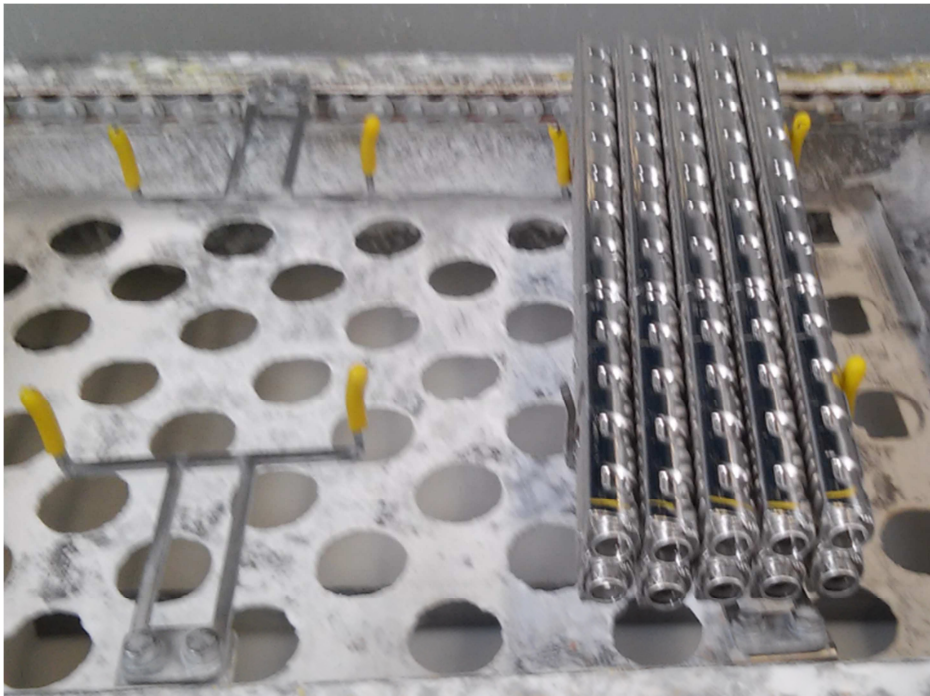
Obr. 4.20 Skládání sběrných trubek do unášeců ponorné vany
