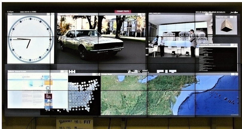
Obrázek 2.1: Stěna 20 dělených displejů na FIT ČVUT (SAGELab) se spuštěným softwarem SAGE2 6
