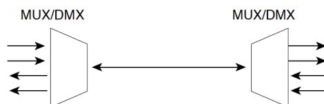
Obrázek 2.6: Multiplexování v obousměrném systému.
