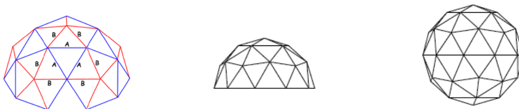
Obr.27) 2V ikosaedr/kupole a sféra (2 délky prutů) (37)
