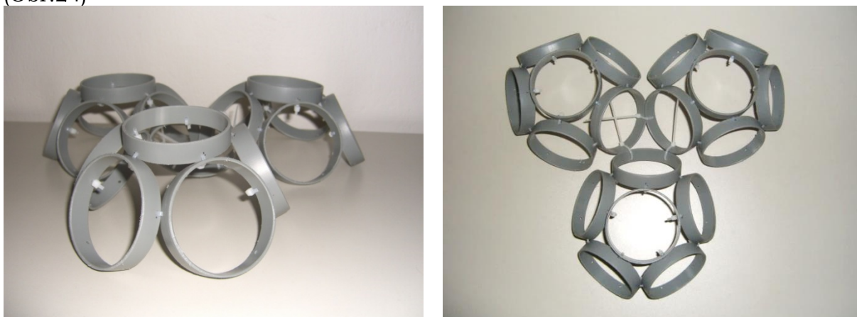
Obr.44) Model sférické klenby odvozený od 2V geodetické kupole
