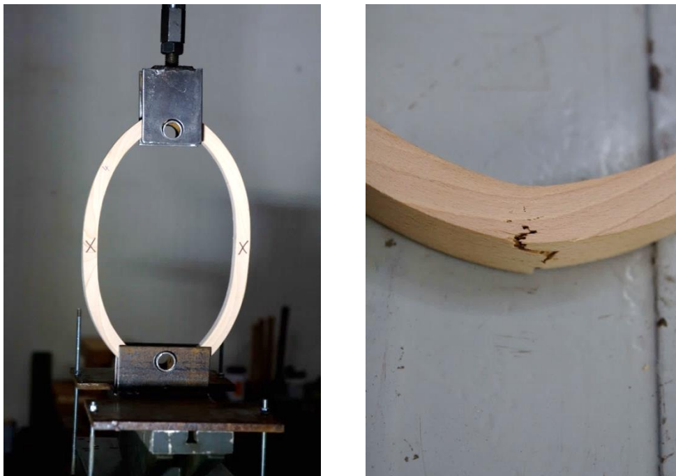
Obr.73) Maximální deformace a porušení vzorku č.4 - zatížení tahem
