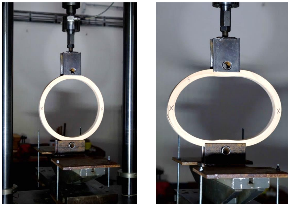
Obr.75) Počáteční stav a výsledné porušení vzorku - zatížení tlakem, vzorek č.5
