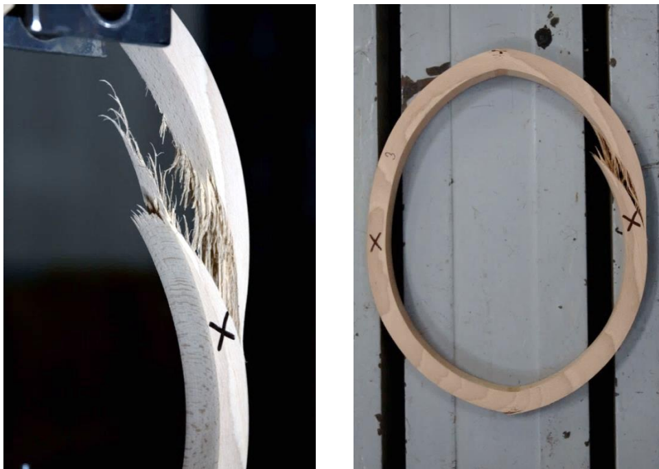
Obr.71) Porušení vzorku č.3 - zatížení tahem
