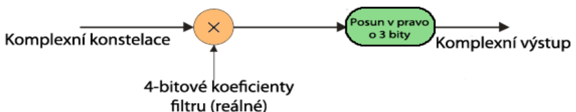
Obr. 23: Blokové schéma filtru preemfáze [7]
