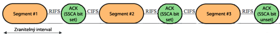
Obr. 29: Znárodnění po sobě jdoucích segmentů dat [7]
