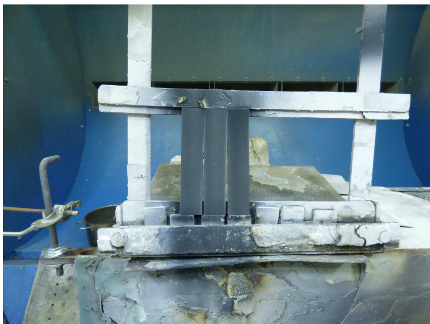
Obrázek 29.: Vzorky po jednom z nástřiků (v prostředním vzorku umístěn termočlánek)
