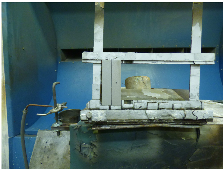
Obrázek 27.: Držák vzorků (substrátů), takzvané "piáno" před nástřikem
