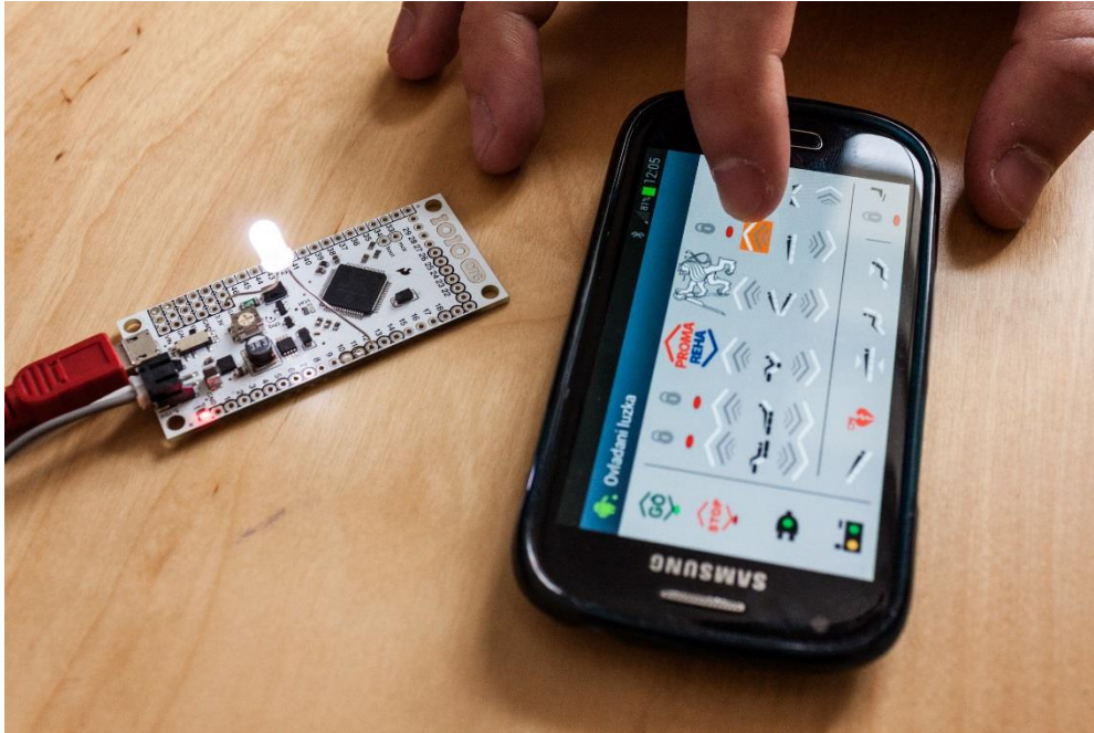
Obr. 13. Stlačenie tlačidla a rozsvietenie led diódy
