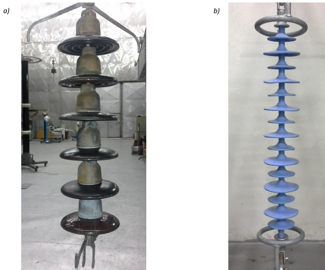
obrázek 8: Zkoušené izolátory. a) porcelánový b) kompozitní
