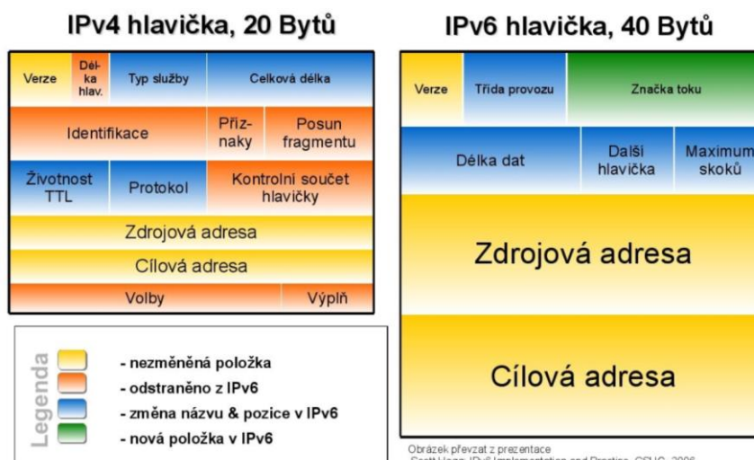
Obr. 10 Porovnání protokolů IPv4 a IPv6 [18]
