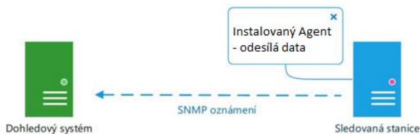
Obr. 5 Příklad pomocí nainstalovaného agenta [9]
