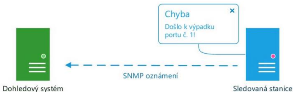
Obr. 4 Příklad sledování pomocí SNMP trap [9]
