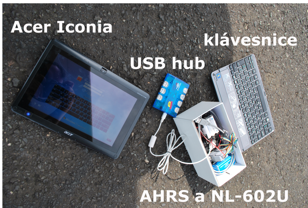
Obrázek 7.2: Rozpojená měřicí soustava před zkušebním letem
