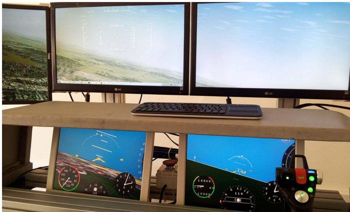
Obr. C5: EFIS 3D (vlevo) a dosavadní EFIS na simulátoru CAST
