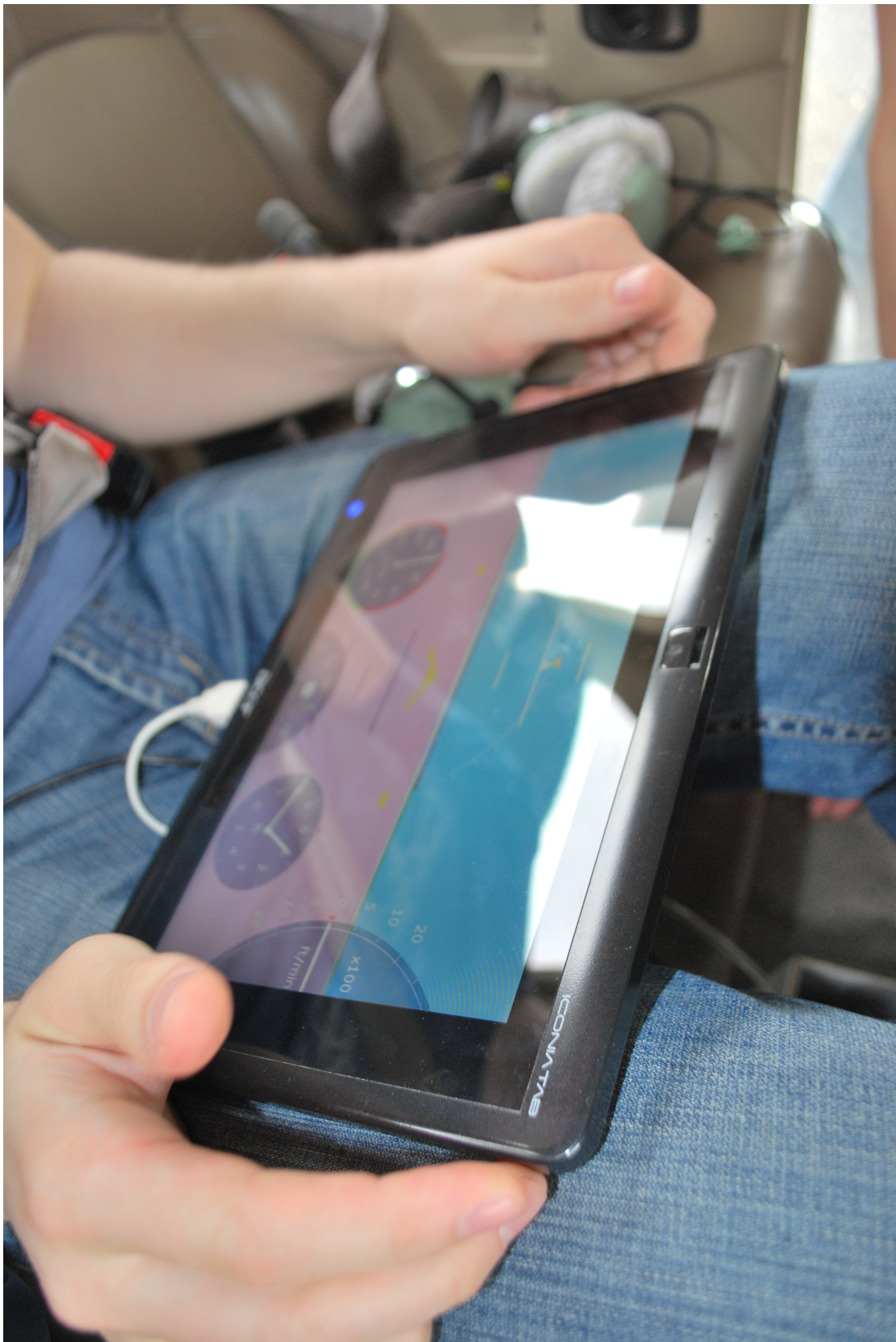
Obr. C6: EFIS 3D během zkušebního letu bez protiodleskové krabice
