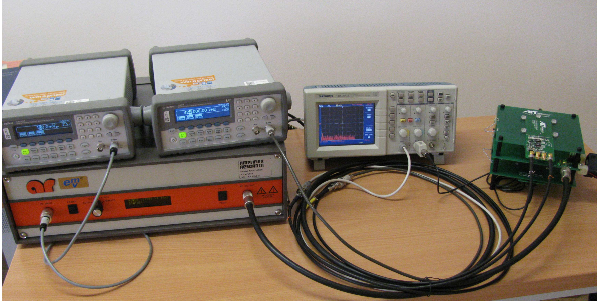
Obrázek 7.7 – Pracoviště pro měření příjmu zátěžové modulace sestavou PCD
