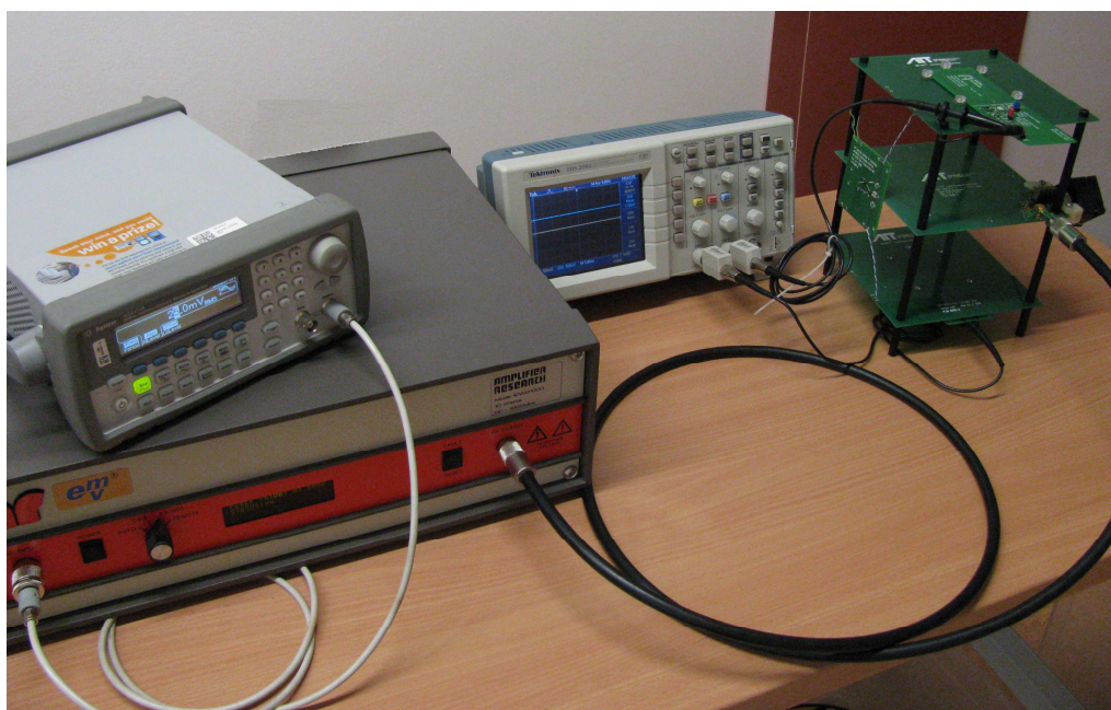
Obrázek 7.9 – Pracoviště pro měření intenzity magnetického pole sestavy VCD
