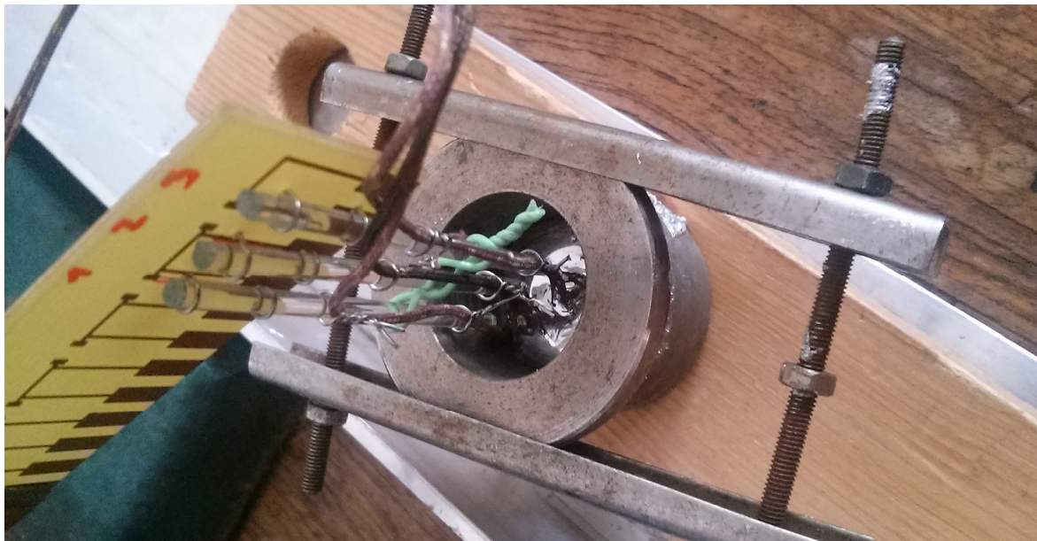
Vzorek č. 3 – pájka měřená třemi termočlánky v kalíšku
