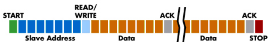
Obrázek 20: I2C sběrnice - datový rámeček(převzato z [13])
