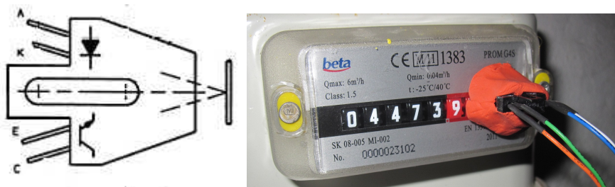
Obrázek 54: Možné umístění optosenzoru na plynoměru
