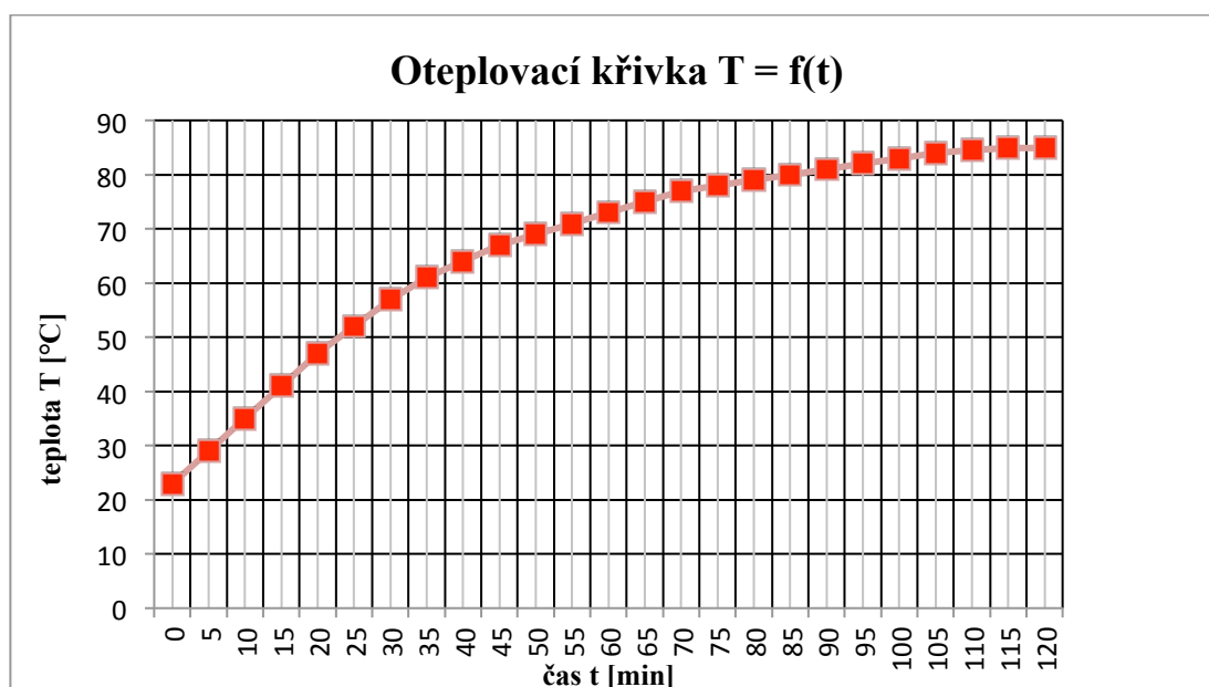
Obr. 16 - oteplovací křivka transformátoru
