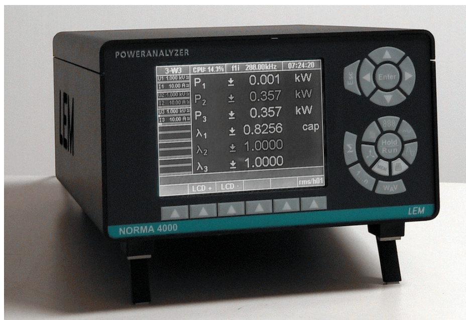
Obr. 23 - výkonový analyzátor Norma 4000
