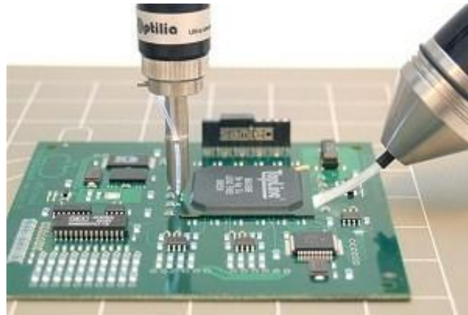
Obrázek 16: Optická kontrola BGA pouzdra pomocí systému Flexia (převzato z [27])
