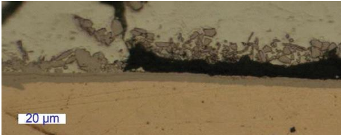
Obrázek 13: Defekt BGA – black pad efekt (přerušené spojení) (převzato z [29])
