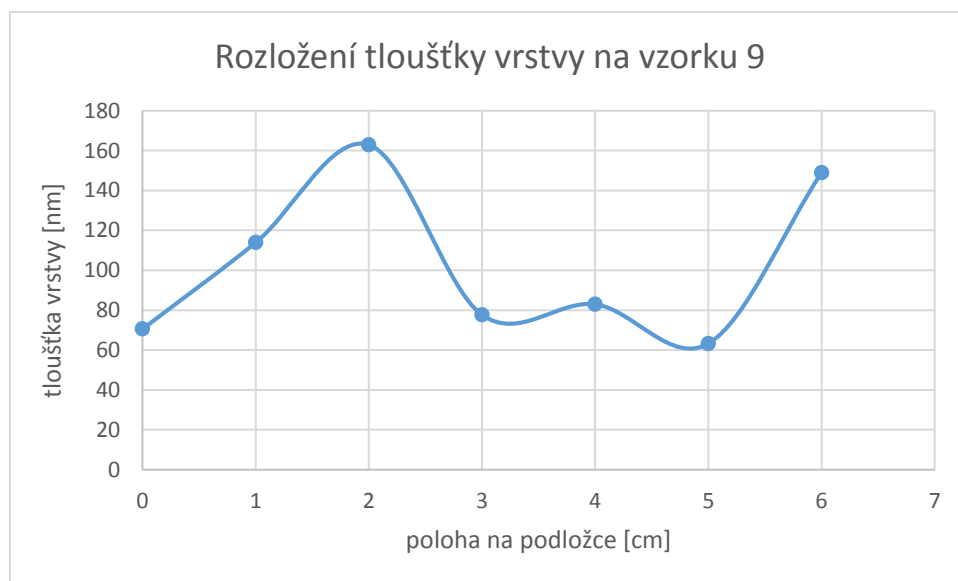
Graf 9 Rozložení tloušťky vrstvy na vzorku 9
