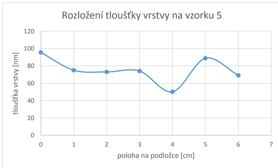
Graf 7 Rozložení tloušťky vrstvy na vzorku 5
