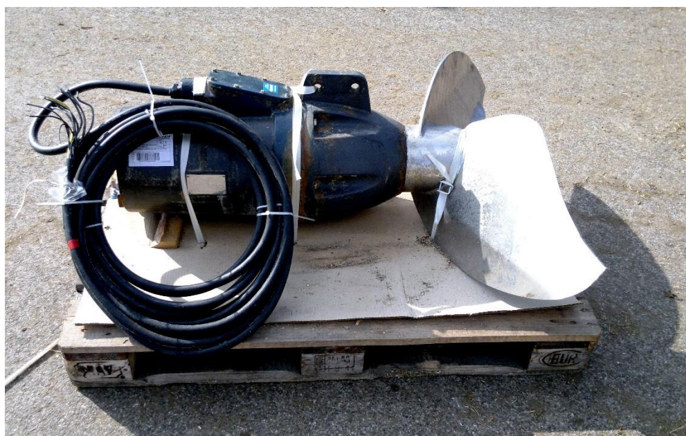
Obrázek 11 : Ponorné míchadlo - 16 kW
