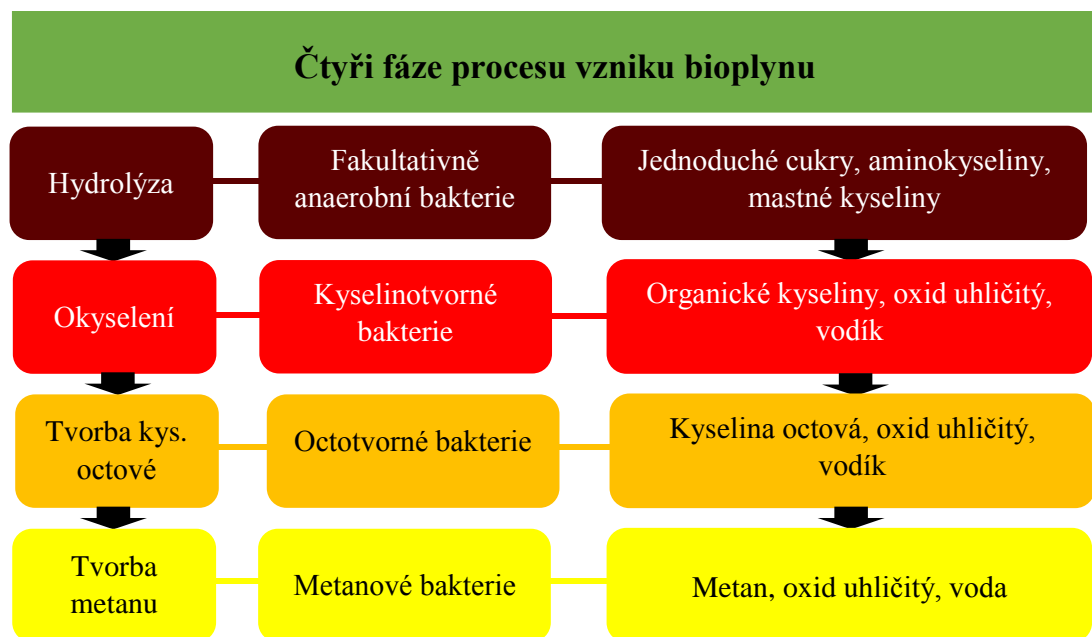
Obrázek 3: Čtyři fáze procesu vzniku bioplynu, převzato z [1]
