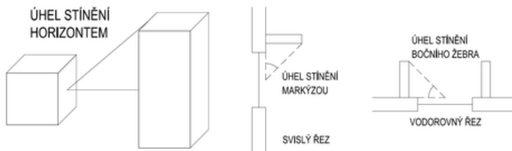
Obr. 4 Znáznornění úhlů stínění jednotlivých překážek [29]
