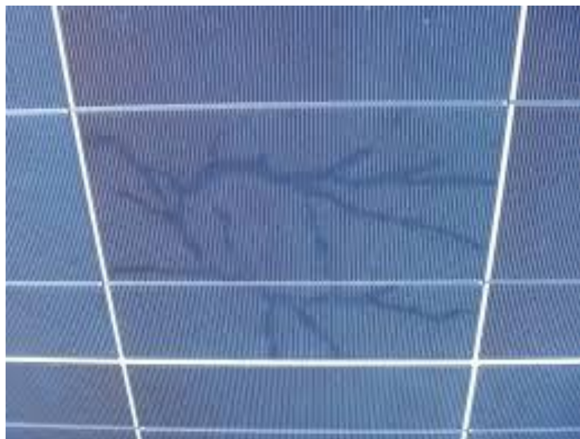
Obr. 7. Šnečí cestičky (Snailtrails) na FV panelu, převzato z [11]
