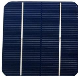
Obr. 1. monokrystalický článek , podle lit. [3]
