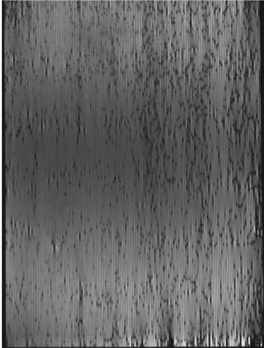
Obr. 24. elektroluminiscence panelu, tenkovrstvý CIGS 95 W
