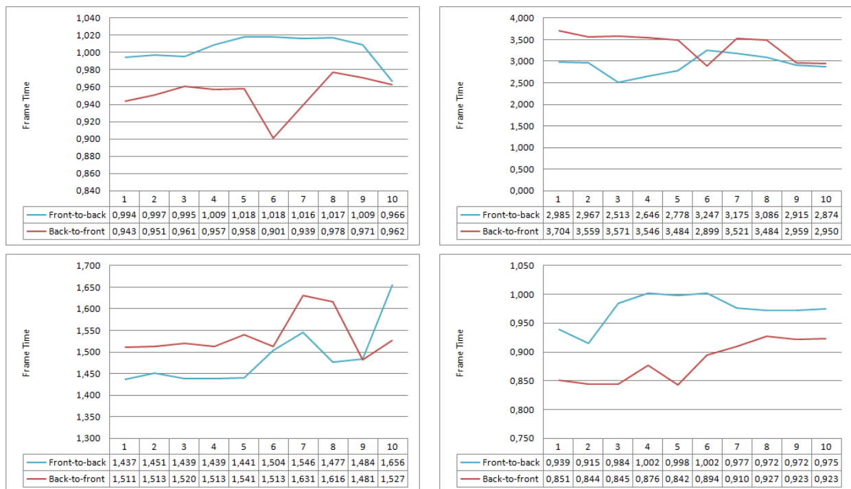
Obrázek 4.5: Výsledky testování výkonu pro transfer funkci b . Použité volumetrické modely: lebkva (vlevo nahoře), motor (vpravo nahoře), vánoční stromek (vlevo dole) a otevřená lebkva (vpravo dole)
