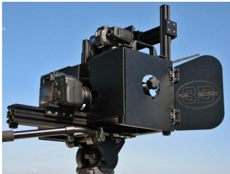
Obrázek 2: Ukázka rigu s polopropustným zrcadlem (převzato z [14])
