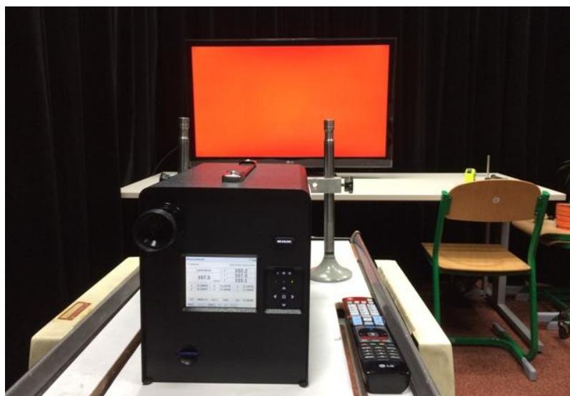
Obrázek 27: Měření přístrojem PR-740 z pozice uživatele
