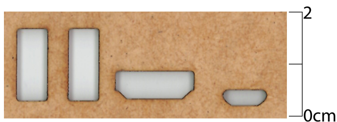
Obrázek 7-4: Ukázka řezu 2,5 mm dřevovláknité desky.
