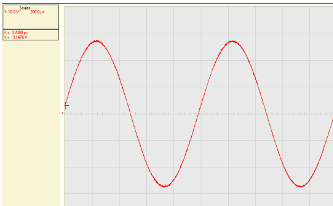
Obrázek 5.18 Integrovaný zesilovač (levý kanál) , časový průběh výstupního signálu, R_z = 4 \Omega , U_{nap} = 50 \text{ V} , U_{vst} = 0,55 \text{ V} , P_{výst} = 95 \text{ W} , f = 1 \text{ kHz}
