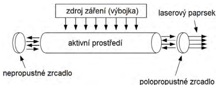
Obr. 3: Obecná struktura laseru [3]
