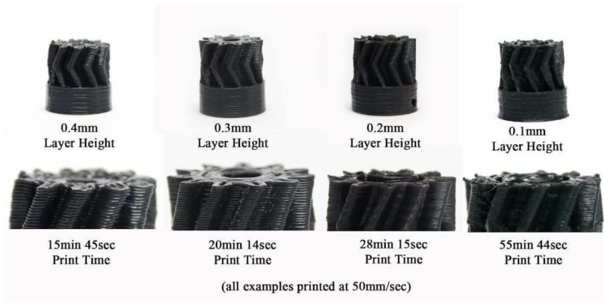
Obr. 1. Porovnání kvality tisku s využitím různých výšek jednotlivých vrstev (převzato z [1]).
