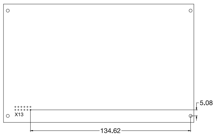
Obrázek 3.5: Umístění konektoru X13 na modulu regulátoru proudu, měřítko 1:2
