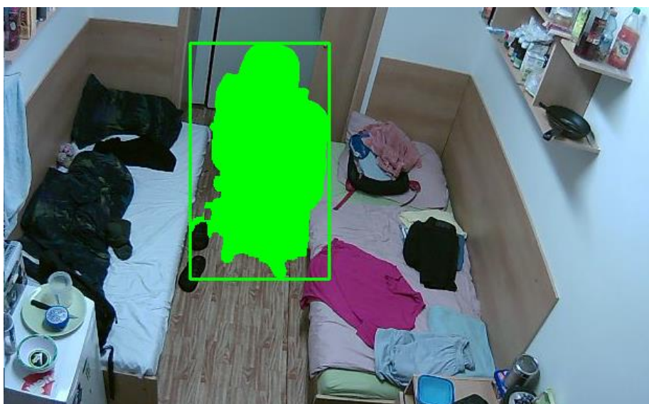
Obr. 38 Vykreslení objektu nalezeného pomocí funkce findContours()
