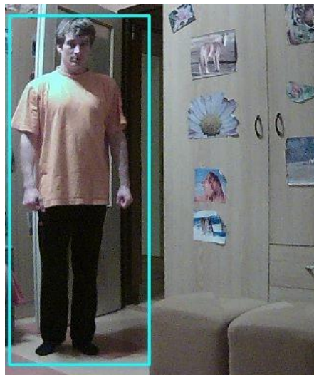
Obr. 41 Příklad úspěšné detekce lidské postavy pomocí histogramu orientovaných gradientů
