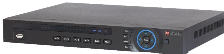
Obr. 6 NVR záznamové zařízení (9)
