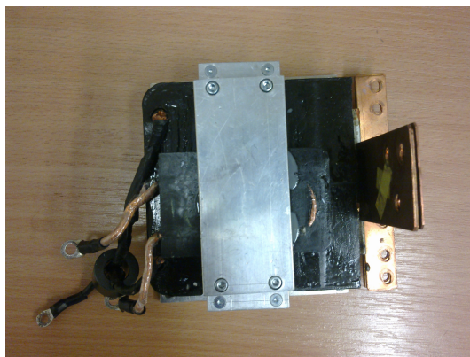
Obrázek 16: Prototyp planárního transformátoru navrhnutý a zkonstruovaný ve firmě POLL, s.r.o.
