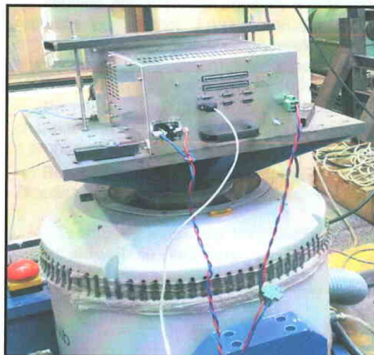
Obrázek 24: Fotodokumentace zkoušky mechanické odolnosti. Příklad ukotvení měniče ve zkušebním přípravku: zkoušky ve svislé ose Z. Obrázek z protokolu o zkoušce mechanické odolnosti, Vojenský technický ústav, s.p. ve Vyškově.
